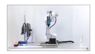
ドライバーを使用したネジ締めシステム Ex.組み立て
